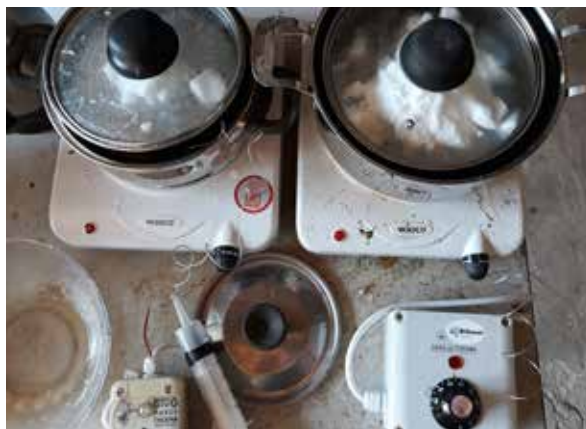
Figur 4. Opstilling til smeltning af thymolkrystallerne. En lille gryde med krystaller er sat i vandbad i en større gryde. Temperaturen af vandbadet kontrolleres med bundvarmestyring. Det er vigtigt at vandet ikke bliver for varmt. Herudover en skål til kogende vand til rensning af sprøjte.
